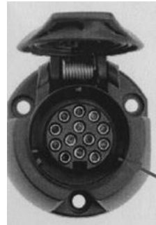
Abb. 5 - Am Fahrzeug befestigtes Steckergehäuse (mit weiblichen Klemmleisten)
