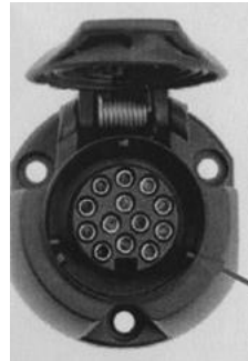
Fig. 5: contrastekker auto (met inwendige contactpunten)
