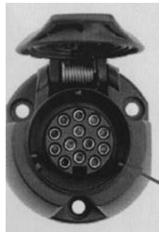
Fig. 5: contrastekker auto (met inwendige contactpunten)
