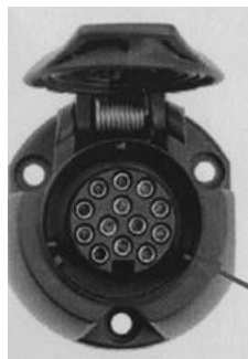
Fig. 5 - Corps de la prise (contenant des bornes femelles) montée sur la voiture
