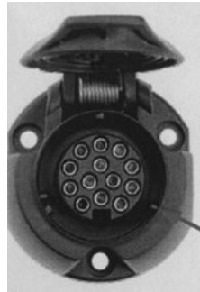
Abb. 5 - Am Fahrzeug befestigtes Steckergehäuse (mit weiblichen Klemmleisten)
