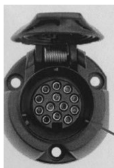
Fig. 5: contrastekker auto (met inwendige contactpunten)
