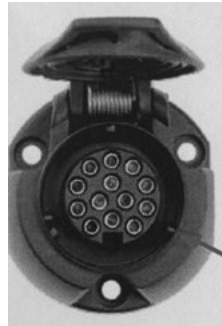
Abb. 5 - Am Fahrzeug befestigtes Steckergehäuse (mit weiblichen Klemmleisten)
