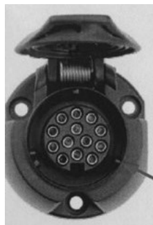
Fig. 5 - Corps de la prise (contenant des bornes femelles) montée sur la voiture
